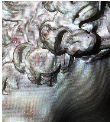
Abb. 3: Teil des Hinterkopfes von David mit aufprojiziertem Gittermuster. © Grafik entstammt dem Projekt, 2017.
