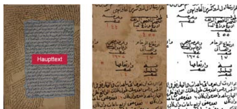
Abb. 1: Seite eines arabischen, historischen Dokumentes mit Haupttext und vielen Kommentaren (links); Beispiel einer Segmentierung der Handschrift mit Hilfe einer Binarisierung: Teil eines Ausgangsbildes (Mitte) und binäres Ergebnisbild (rechts) (Quelle: Autoren).
