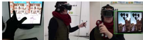
Abb. 2: Datenhandschuh, Hand-Tracer sowie entsprechende Darstellungen in einer virtuellen Umgebung (Fotos: Peer Schlieperskötter, 2014).
